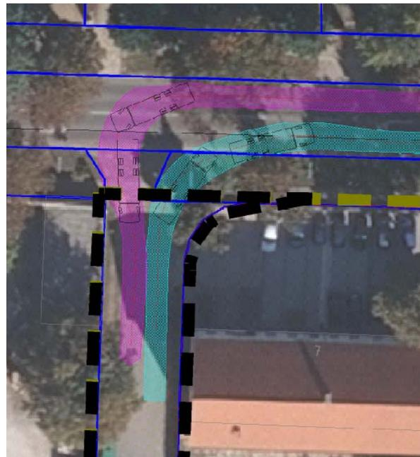
Abb. 5: Schleppkurve (links rein / rechts raus)
